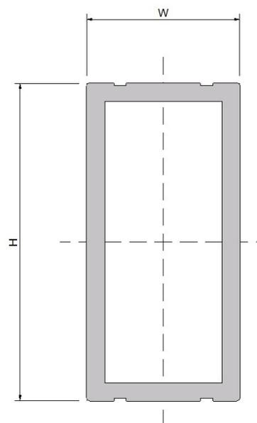
**MATERIALE:** termoplastico rinforzato vetro**COLORI:** (sim.) RAL 9004, (sim.) RAL 7035 e (sim.) RAL 7040
