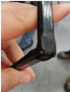
Angle soudé recouvert de butyl
